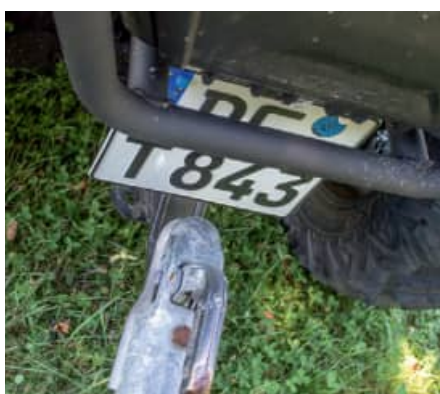
▲ Das ist Murks: Die Zugvorrichtung müsste weiter weg vom Chassis gebracht werden.
